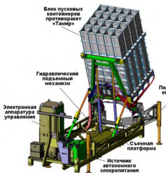
Рисунок 13 – Основные элементы пусковой установки
