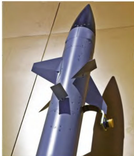
Рисунок 17 – Головная часть и органы аэродинамического управления ЗУР «Тамир»
