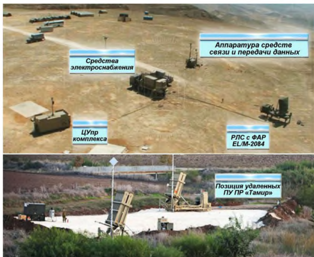
Рисунок 9 – Размещение элементов ПРК «Железный купол» на боевой позиции
