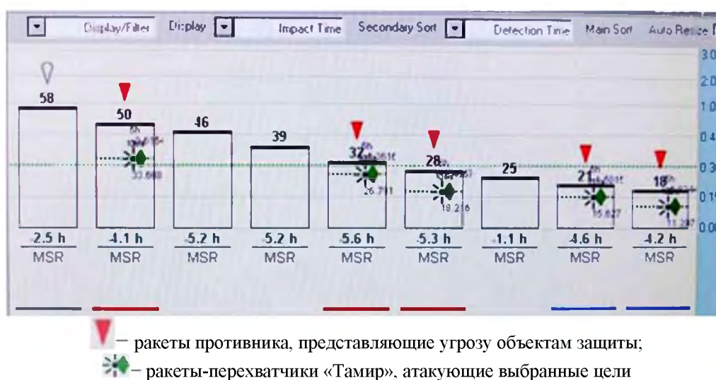
Рисунок 21 – Отображение тактической обстановки в виде гистограммы на дисплее АРМа оператора пуска
