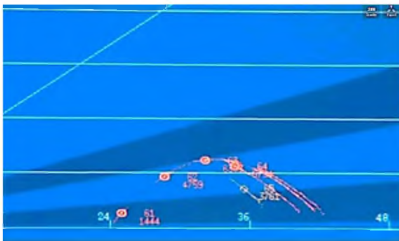
Рисунок 12 – Отображение воздушной обстановки на экране АРМа, получаемой от РЛС EL/M-2084 (вертикальная плоскость)
