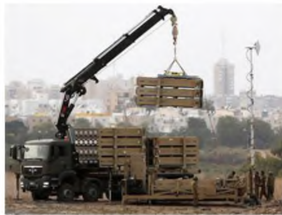
Рисунок 16 – Перезарядка ПУ с ЗУР «Тамир» с помощью автокрана
