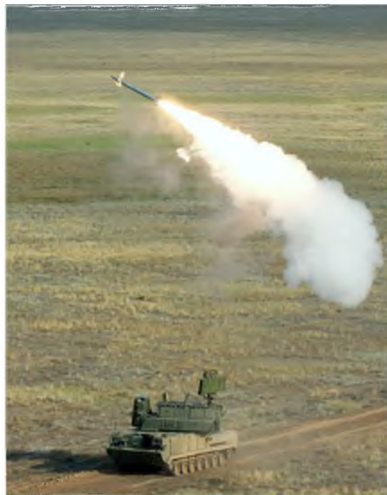
Рисунок 29 – Вертикальный «холодный» старт ЗУР 9М331 ЗРК «Тор-М2У»
