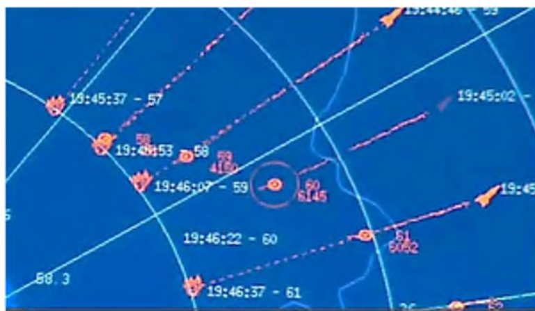
Рисунок 11 – Отображение воздушной обстановки на экране АРМа, получаемой от РЛС EL/M-2084 (горизонтальная плоскость)
