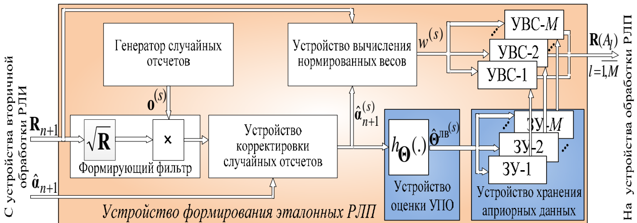
Рисунок 6. – Структурная схема устройства формирования эталонных РЛП с учетом аппроксимации плотности вероятности УПО объекта
