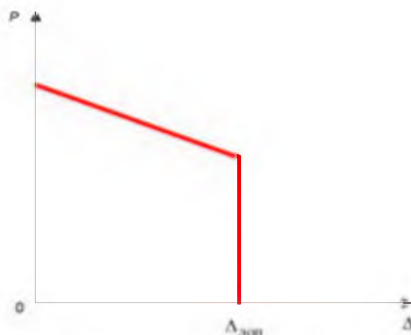
Рисунок 4 – Условие работоспособности изделия для модели контроля по обобщенному параметру
