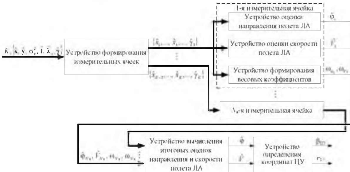
Рисунок 2 – Структурная схема устройства определения координат ЛА в электростатической МСПЛ
