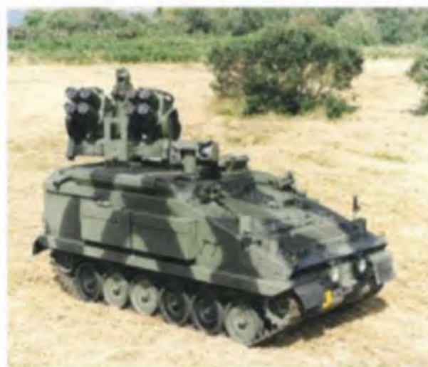
Рисунок 7 – Размещение ЗУР «Старстрик-2» на бронемашине Stormer
