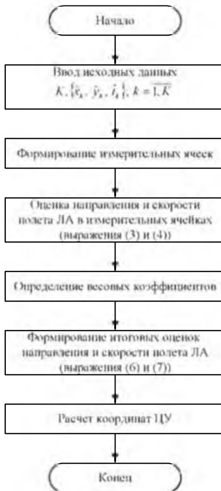
Рисунок 1 – Алгоритм определения координат в электростатической МСПЛ
