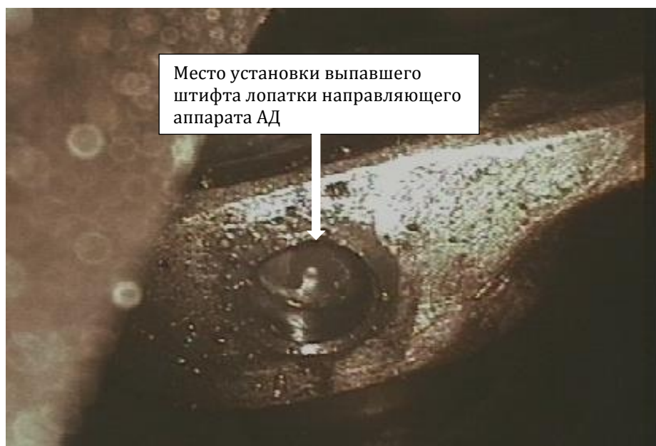
Рисунок 2. – Крепление штифта лопатки направляющего аппарата ГТД
