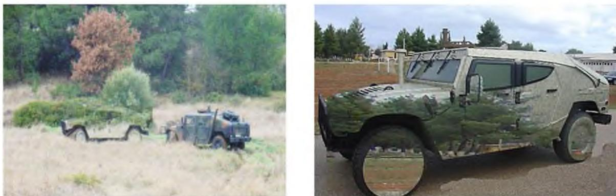
Рисунок 1. – Применение маскирующего окрашивания автомобиля
