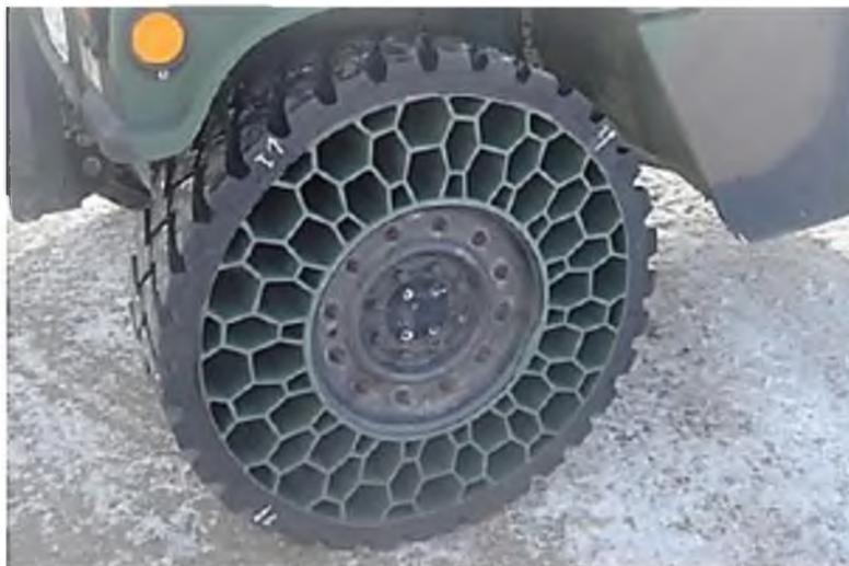
Рисунок 7. – Непневматическое колесо типа NPT
