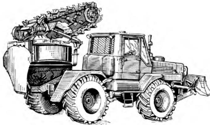
Рисунок 1. – Траншейно-котлованная машина ПЗМ-2
