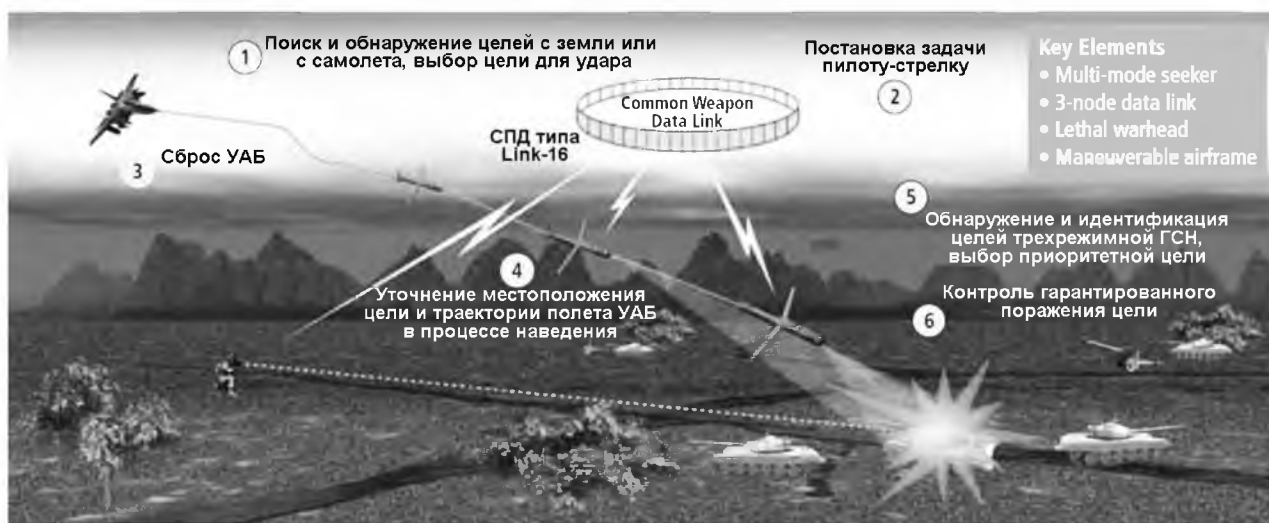
Рисунок 14. – Схема боевого применения УАБ GBU-53/B
