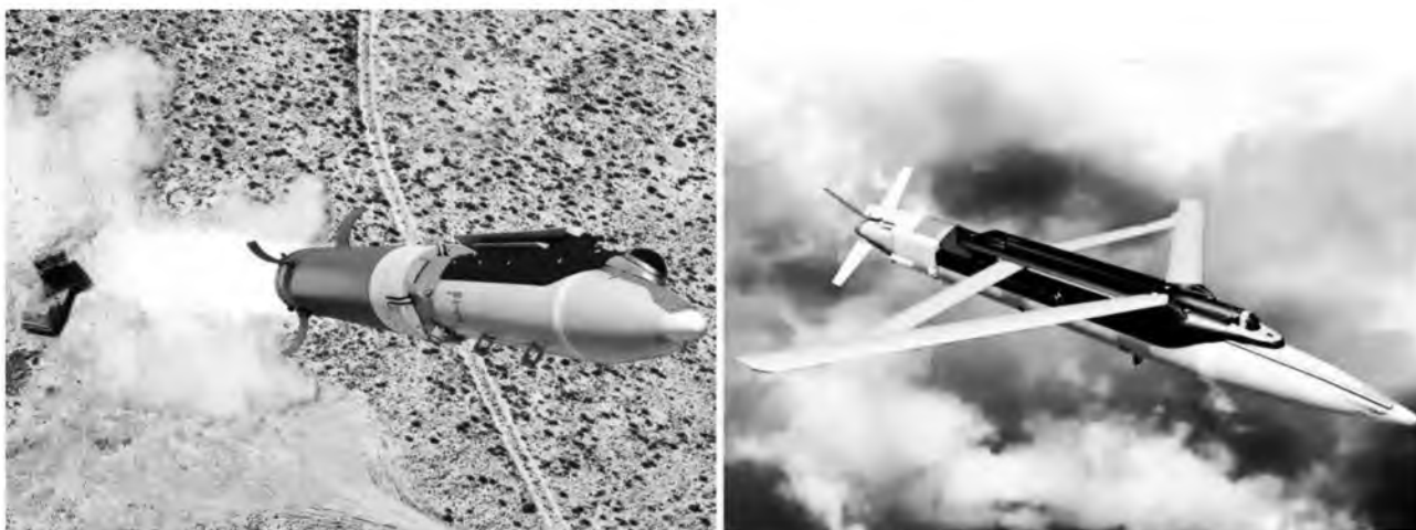
Рисунок 16. – Высокоточный управляемый боеприпас GLSDB с УАБ GBU-39В в качестве головной части неуправляемой ракеты M26, запускаемой с РСЗО типа MLRS
