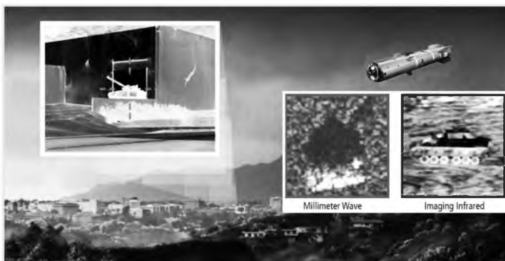
Рисунок 9. – Тепловизионное и радиолокационное изображение цели, получаемое трехрежимной ГСН управляемой ракеты JAGM
