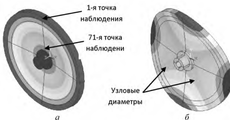
Рисунок 4. – Четвертая (а) и пятая (б) собственные формы колебаний диска
