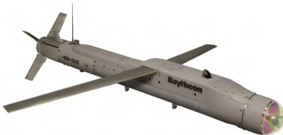
Рисунок 12. – Внешний вид крылатой управляемой авиабомбы малого диаметра GBU-53/B
