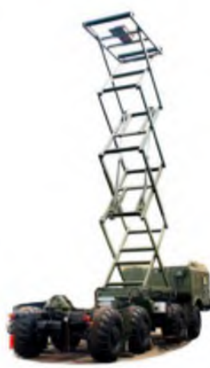
Подъемник ножничный: грузоподъемность – до 1200 кг; высота подъема от основания – 10,1 м
