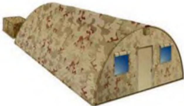
Рисунок 8 – Передвижная зарядная станция из окрашенных полимерных солнечных элементов, расположенных на крыше и стенах помещения
