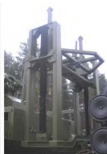
Подъемник винтовой: грузоподъемность – до 3000 кг; высота подъема от основания – 2,2 м
