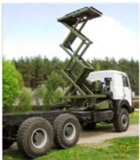
Подъемник ножничный: грузоподъемность – до 500 кг; высота подъема от основания – 4 м
