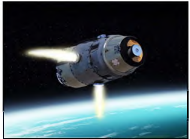
Рисунок 10. – Кинетическая боевая часть ракеты SM-3
