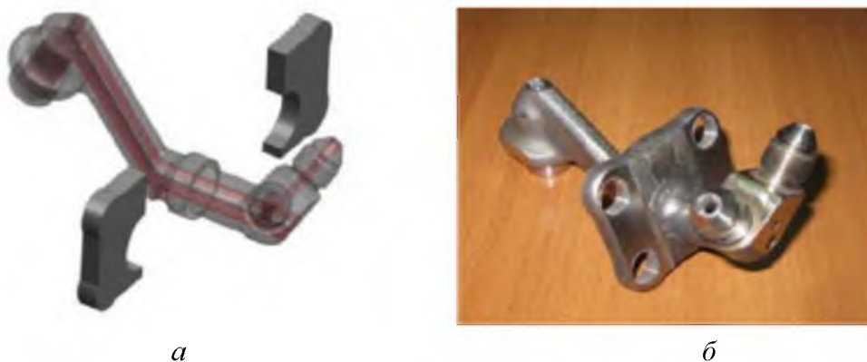
Рисунок 2. – Сварная (а) и «выращенная» (б) по методу СЛС топливная форсунка
