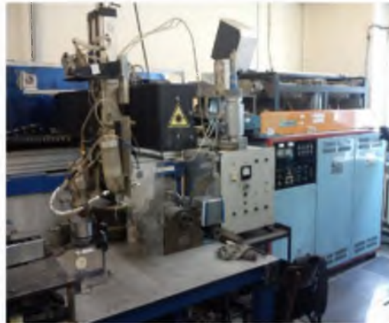
Рисунок 4. – Установка «Комета 2» для селективного лазерного спекания
