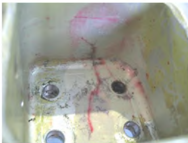
Рисунок 2 – Трещина кронштейна узла крепления крыла (самолет Су-25)
