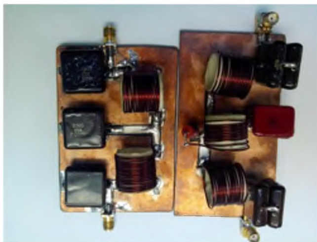
Рисунок 7 – Практическая реализация фильтров: левый классический фильтр Чебышева, правый – модифицированный фильтр Чебышева
