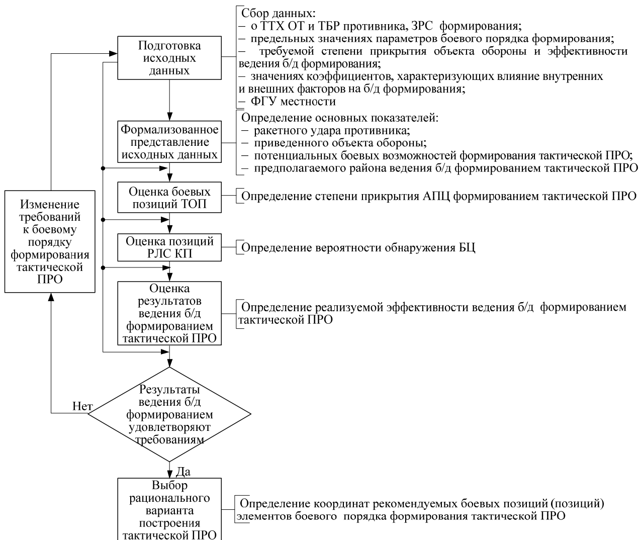
Рисунок 1. – Схема выбора рационального варианта построения боевого порядка формирования тактической ПРО
