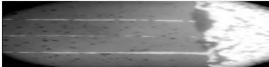
Рисунок 3. – Изображение участка образца с дефектными электродами в центре образца (а) и вблизи контактного торца конденсатора (б)
