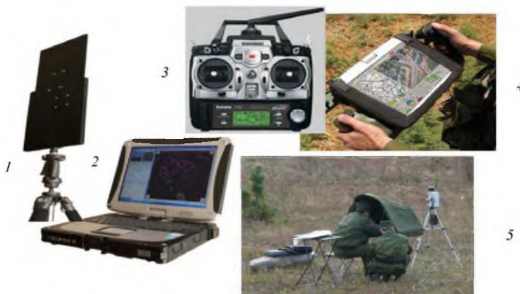
1 – антенная часть приемо-передающей аппаратуры; 2 – унифицированный защищенный ноутбук; 3 – унифицированный пульт визуального управления полетом БЛА; 4 – унифицированный пульт дистанционного управления полетом БЛА; 5 – вариант размещения ГПУ
