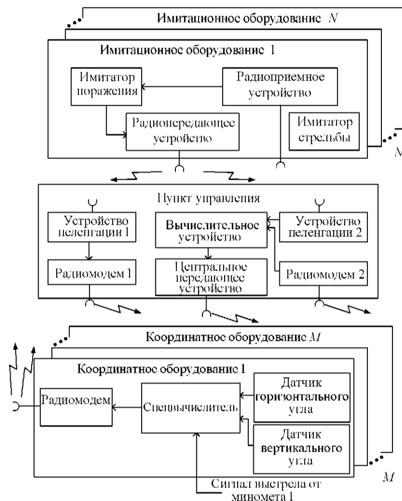
Рисунок 1. – Структурная схема полевой тренажерной системы
